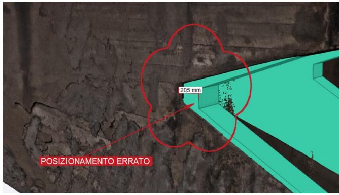
Figura 8: Verifica di compatibilità mediante sovrapposizione del modello BIM strutturale con la nuvola di punti
