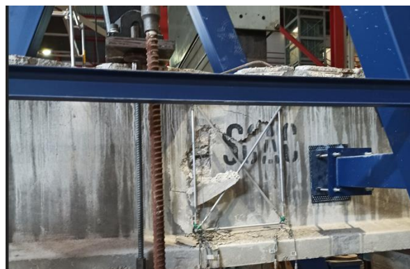
Figura 14. Rottura della trave-Seconda Prova
