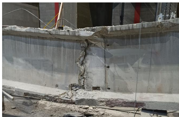
Figura 13. Rottura della trave-Prima Prova
