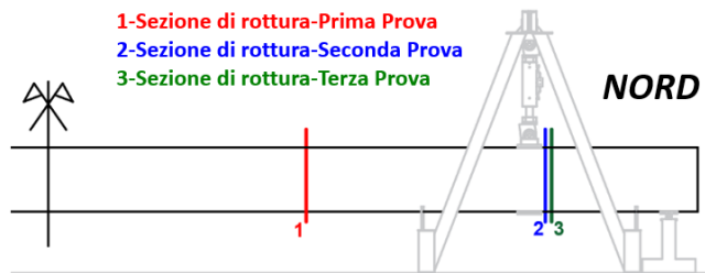
Figura 16. Sezioni di rottura
