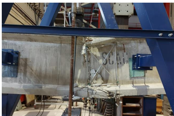
Figura 15. Rottura della trave-Terza Prova.
